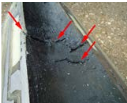
Фото 2. Разрушение внутреннего стеклопластикового вкладыша
